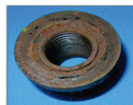
劣化したホイール・ナット
